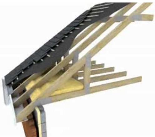
Figura 4. Izolarea termică a acoperișului a) tavan suspendat b) plafon suspendat 6
